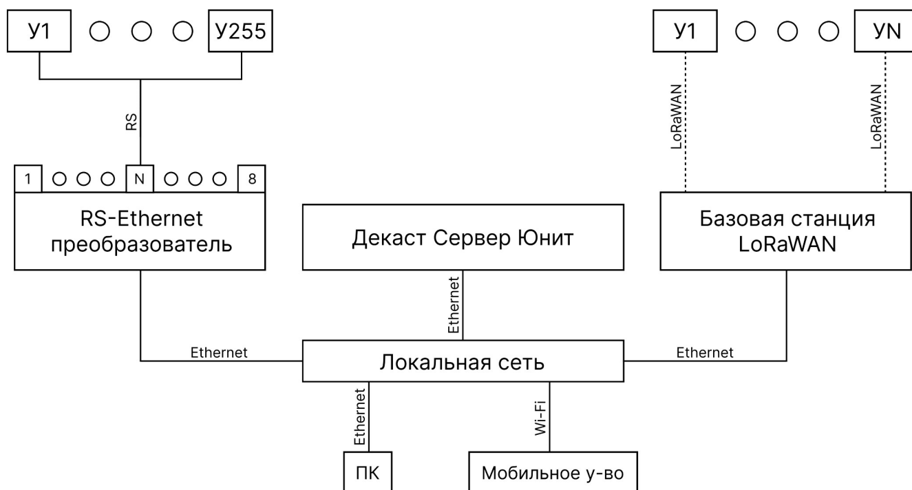
Рисунок 14 – Концептуальная схема подключения приборов учета к Декаст Сервер Юнит
