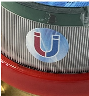
Рисунок 4 — Место воздействия магнита на счетчик
