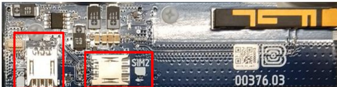
Рисунок 11 – Расположение разъемов для SIM-карт
