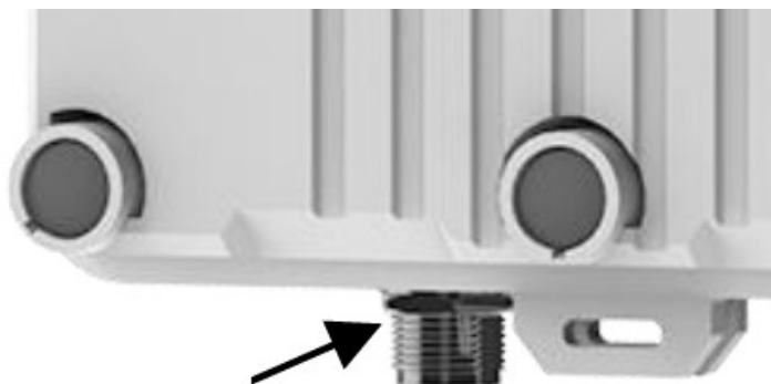
Рисунок 12 – Расположение коннектора для антенны
