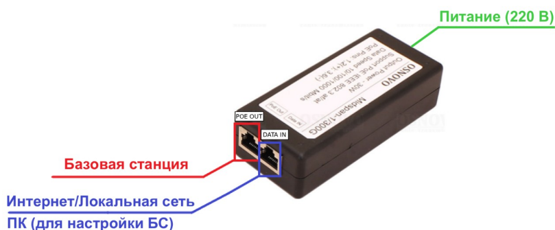
Рисунок 8 – Описание разъемов PoE-инжектора
