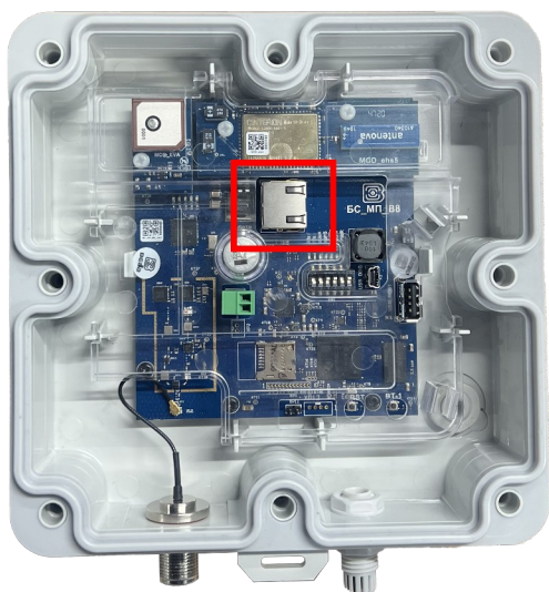
Рисунок 10 – Разъем для подключения к PoE-инжектору
